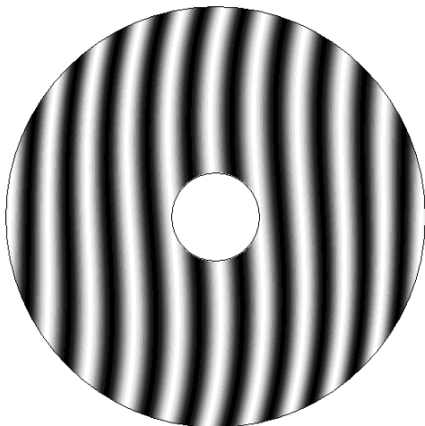
Рисунок 17 – Модельная интерферограмма децентрировочной комы
