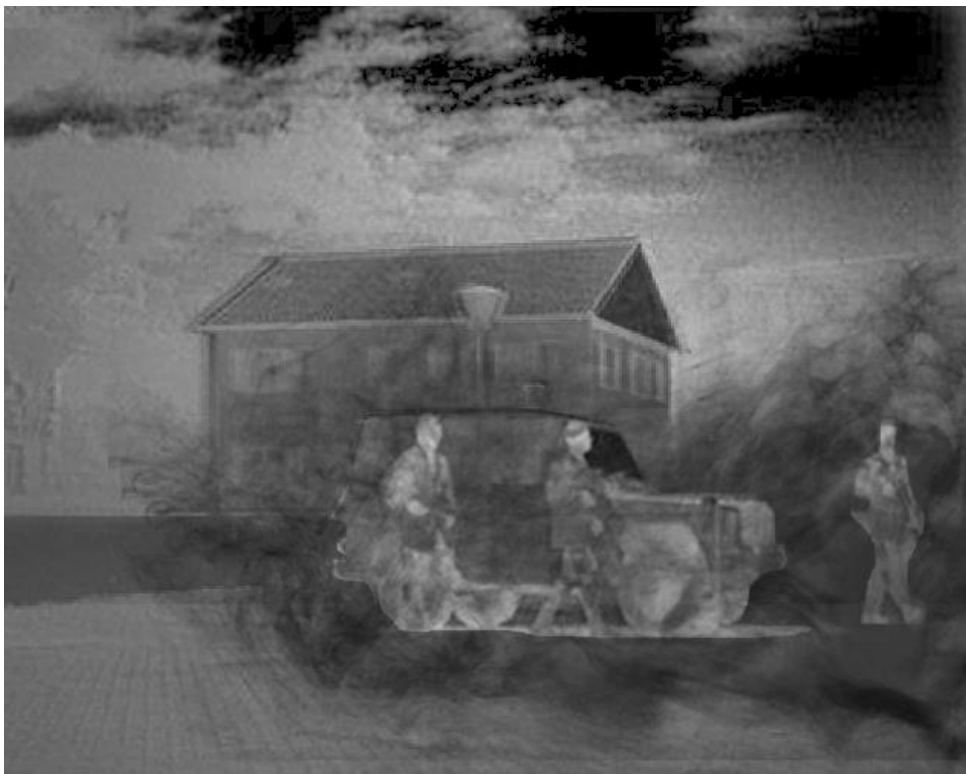
Рисунок 8 – Комплексированное изображение, полученное методом степенного преобразования
