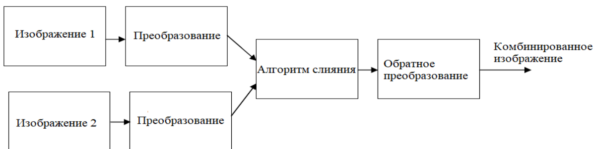
Рисунок 3 – Общий алгоритм работы декомпозиционных методов [3]
