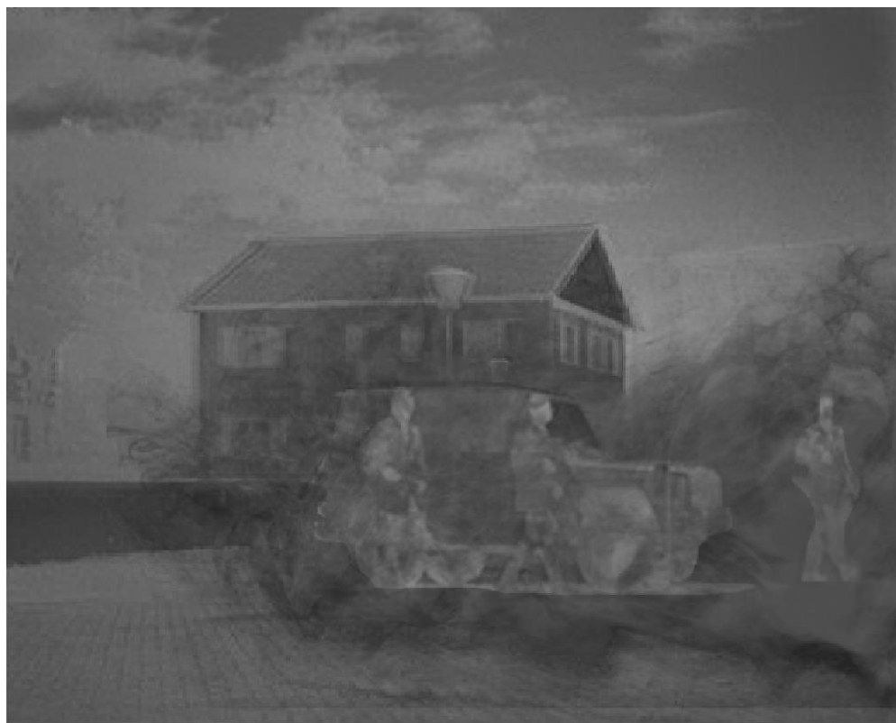
Рисунок 7 – Комплексированное изображение, полученное методом суммирования с весовыми коэффициентами
