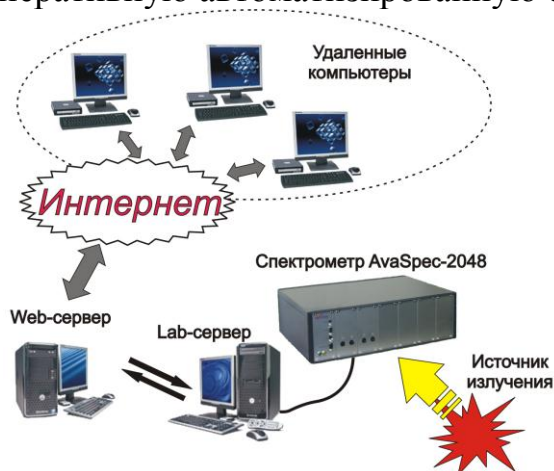
Рис. 3. Схема проведения эксперимента по спектроскопии через глобальную сеть
