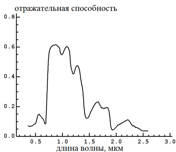
Рисунок 5 – Спектр отражения можжевельника
